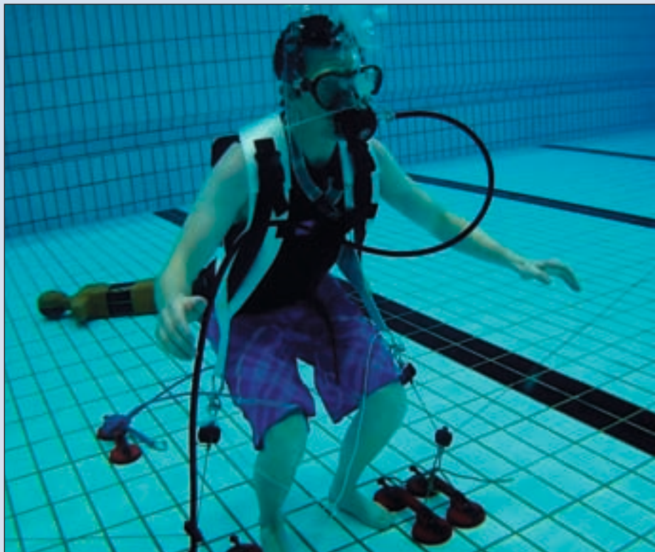
Træning under vand, hvor en række taljer og to motorer over vandet – styret via en algoritme – skaber kunstig tyngdekraft.
