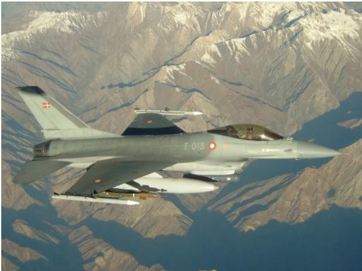
Dansk F-16-fly fotograferet over Afghanistan i 2003. Bemærk LANTIRN-poden, der er den mørkegrå pod under flyets bug. (FLV Foto)
