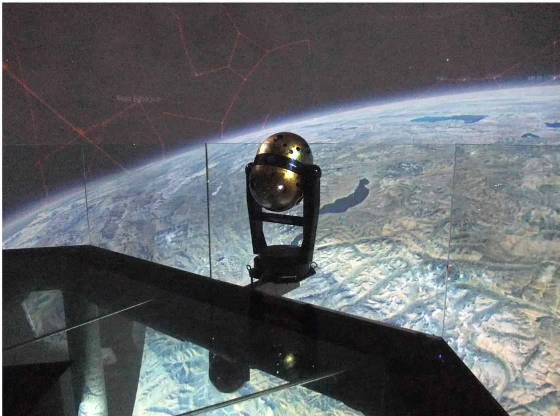
Abbildung 8.1: In der Kuppel des AHHA Science Centers in Tartu, Estland. Diese Kuppel zeigt mehr als 180°. Die Besucher befinden sich auf einer Glasplattform mitten im Raum, die Projektionstechnik ist unter ihnen. Die Kuppel ist hybridfähig, im Bild ist der Sternenprojektor zu sehen.
