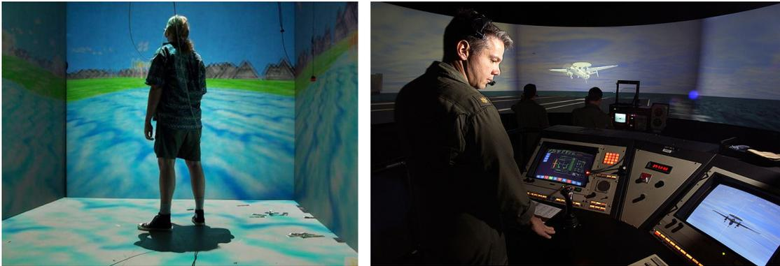
Abbildung 3.6: Virtuelle Realitäten: CAVE mit Stereo3D-Projektion und kabelgebundenem Tracking (links), Flugsimulator der US Navy (rechts).
