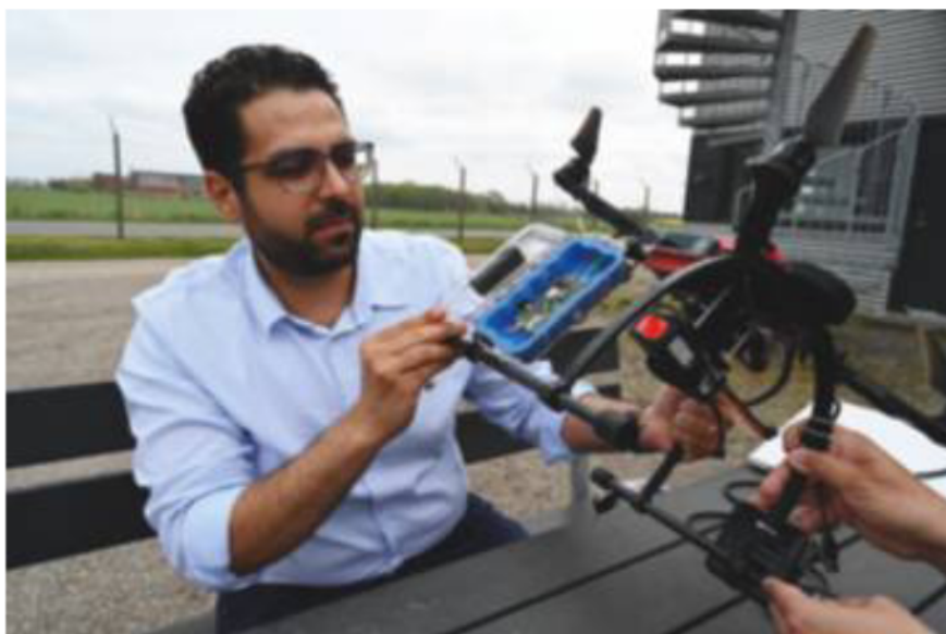
Professor Emad Samuel Malki Ebeid med en af prototyperne på en drone, der kan lade sine batterier fra højspændingsledninger.
