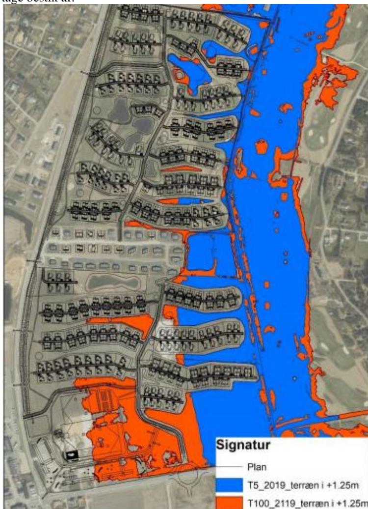
Figur 2-5 Visning af mulige udbredelser samt kote for en nuværende 24 timers regn med gentagelsesperiode på 5 år samt en fremtidig 24 timers regn med gentagelsesperiode på 100 år beregnet på de fremtidige terrænforhold hvor veje og områder med bebyggelser er hævet til kote +1,25m. Der er forudsat at pumpens fulde kapacitet (1m 3 /s) er til rådighed og der er således ikke indregnet tørvejrflow samt fremskrivning af tørvejrflow over tid.
