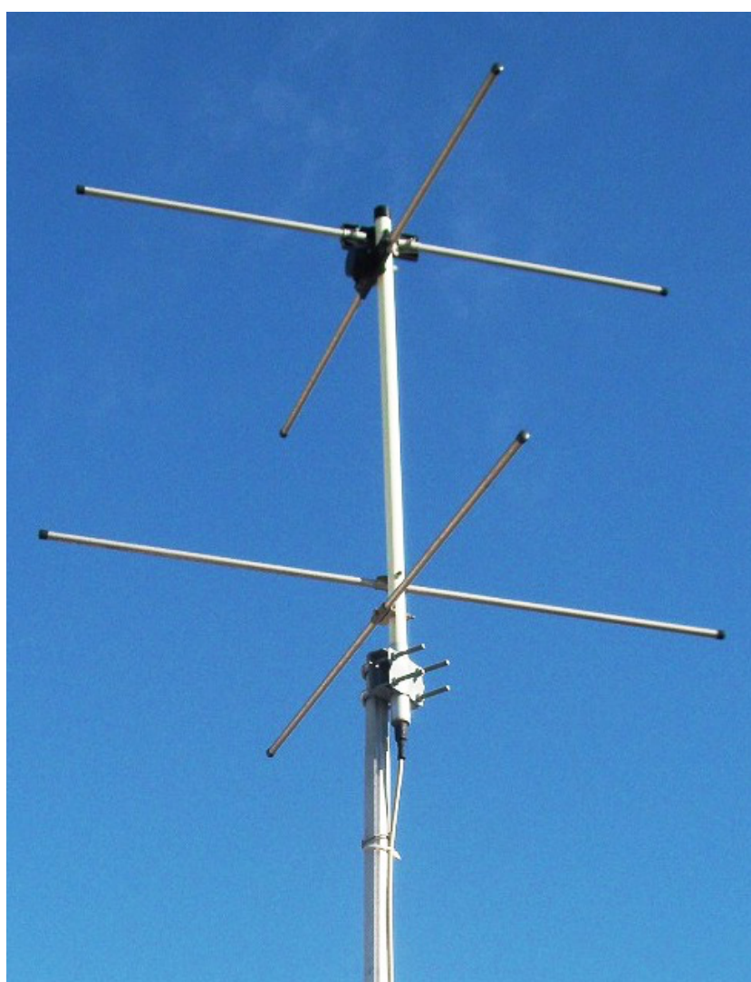
Figur 31: En krydset dipol, eller turnstile-antenne, til modtagning af cirkulært polariserede signaler. De to dipoler sidder øverst; længere nede sidder to reflektorer, der giver antennen lidt retningsvirkning opad. Så teknisk set er der tale om to krydsede to-element-Yagier. 16
