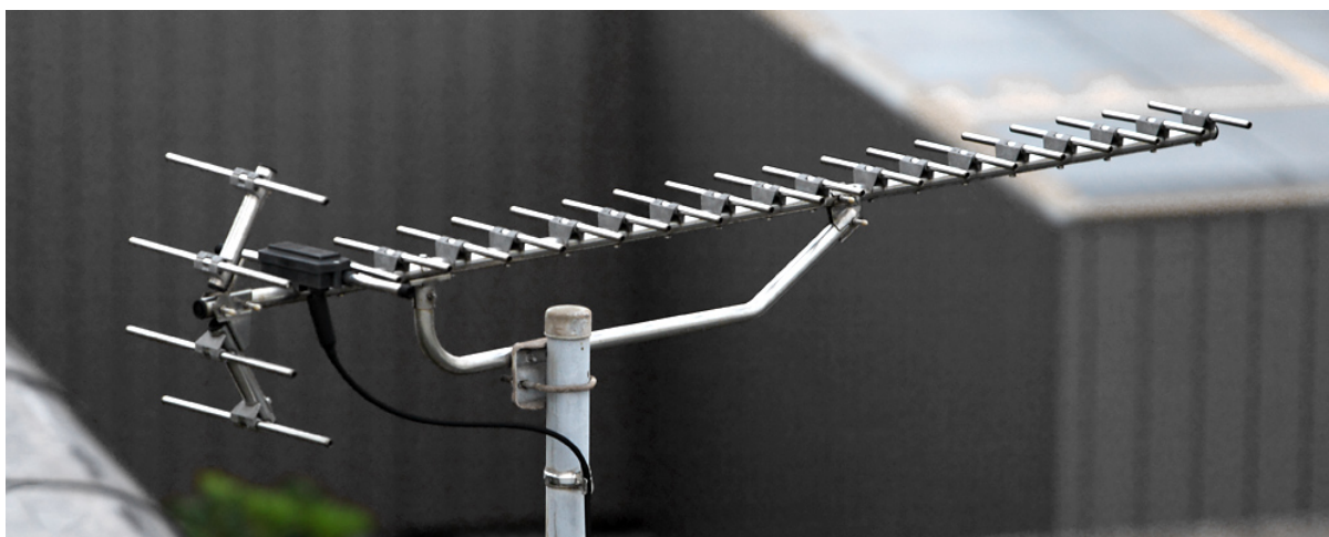
Figur 27: En moderne high-gain UHF Yagi-antenne med 17 direktorer, og en reflektor, der består af fire elementer, formet som en hjørnereflektor. 13
