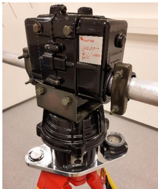
Figur 14: Yaesu G5500-rotor til styring af antenne. Nederst kan hele opstillingen dreje omkring den lodrette akse (azimut), og metalrøret, der går igennem rotoren kan rotere omkring den vandrette akse (elevation).
