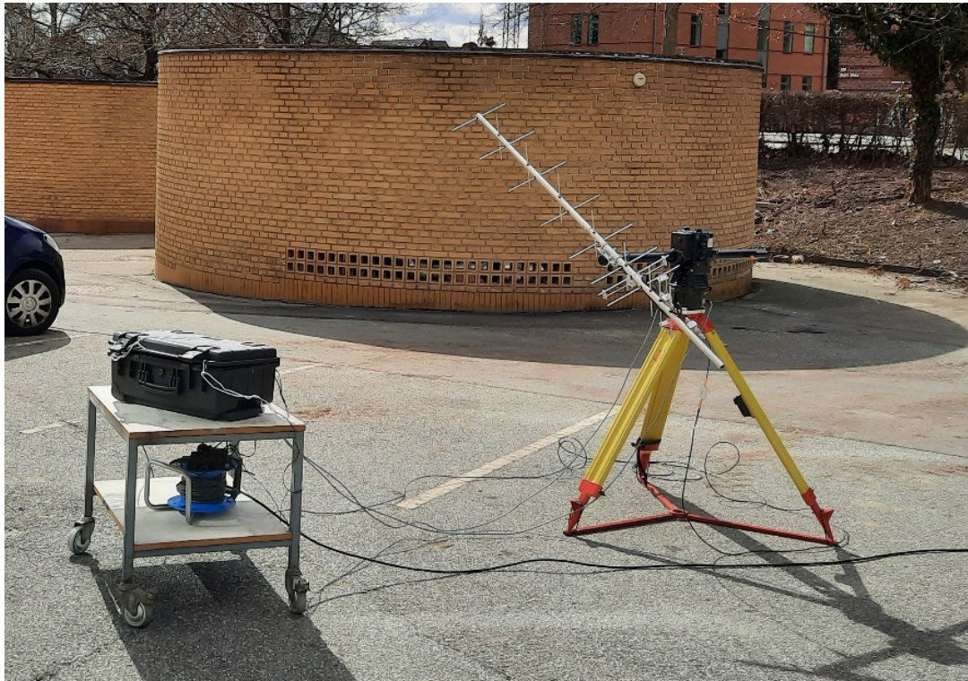
Figur 13: En af de mobile SatNOGS-jordstationer med rotérbar antenne.
