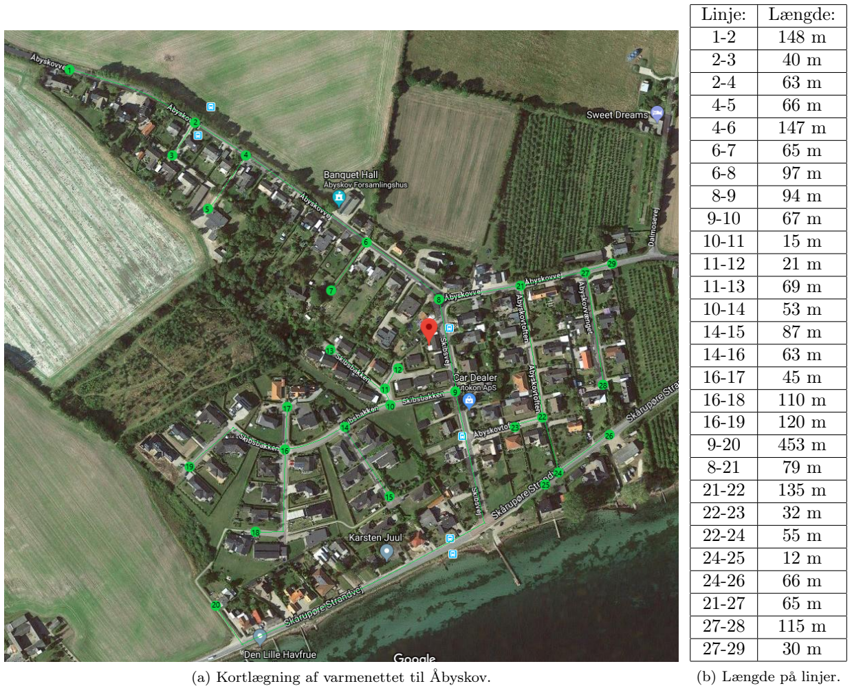
Figur 4: Tegning over det teoretiske varmenet i Åbyskov med noder og linjer, samt tabel over længden på de forskellige linjer.
