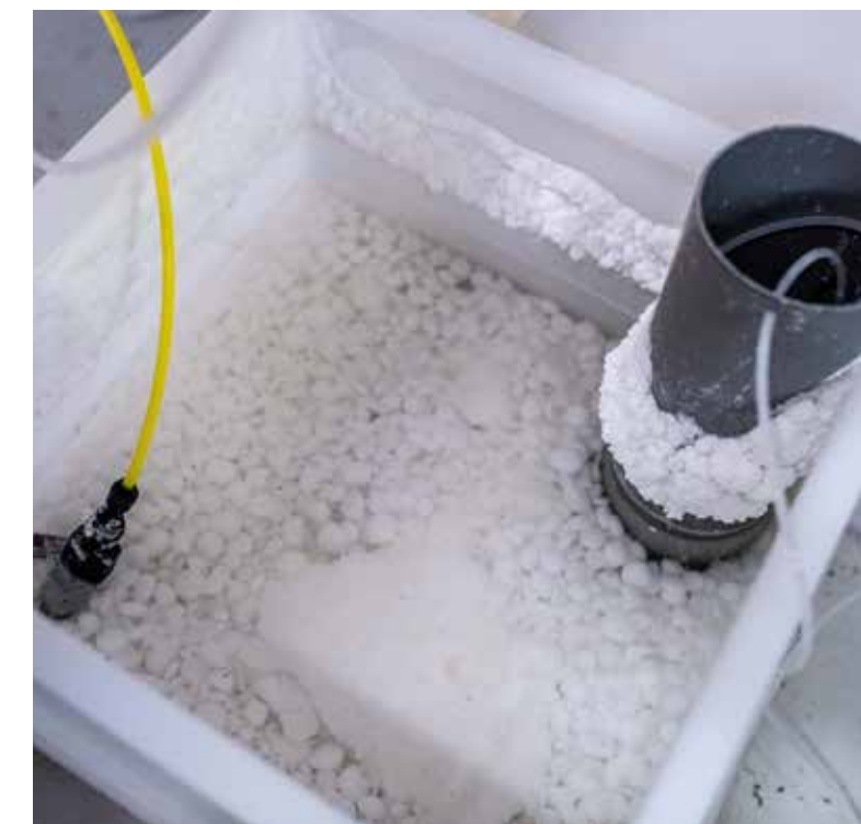
Anlægget producerer en desinfektionsvæske, som bekæmper bakterier.
