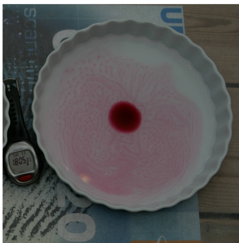
Figur 17: Diffusionsforsøg. Diffusionskonstanten bestemmes ved at dryppe rød frugtfarve i stillestående vand. Udbredelsen måles som funktion af tiden.
